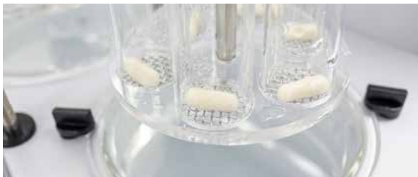
Capsules à enrobage entérique qui ont résisté à un test d'acide gastrique simulé pendant 90 minutes.
